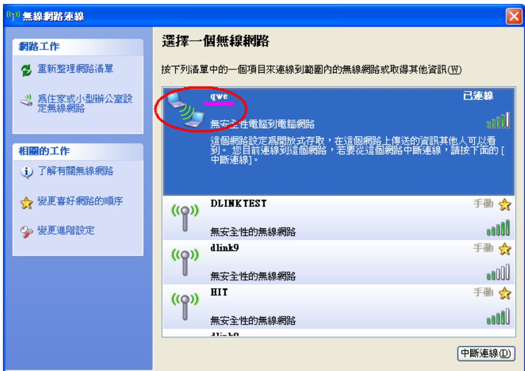
圖 5.1.3 錯誤案例 Ad Hoc 「無線網路連線」視窗-NB 筆記型電腦 b
